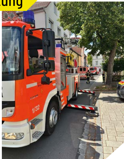
6.9.2025 // 09:13 Uhr Unterstützung des Rettungs- dienstes beim Transport der Patienten aus dem Gebäude durch die Drehleiter, da bei zu engen Treppenträumen der Transport liegend mit der Trage im Gebäude nicht möglich ist.
